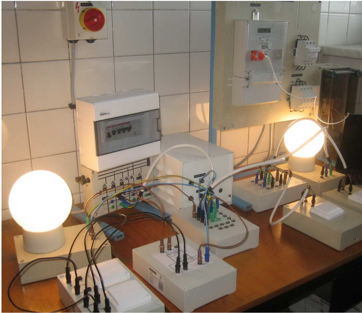
Ukázka měřicího stanoviště laboratorní úlohy Světelná domovní instalace
