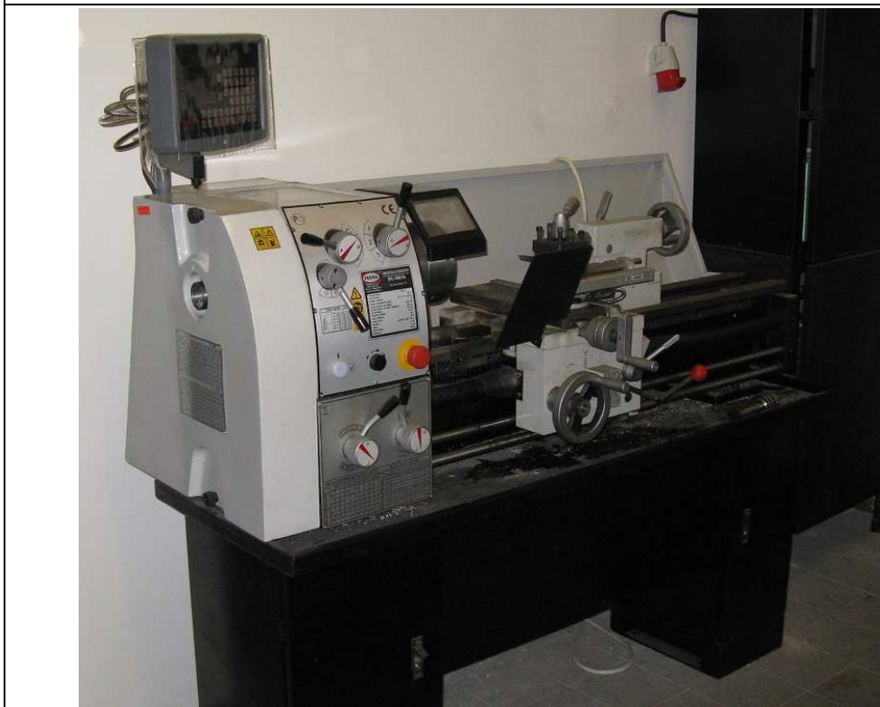
Univerzální soustruh SPC900A – po instalaci a oživení
