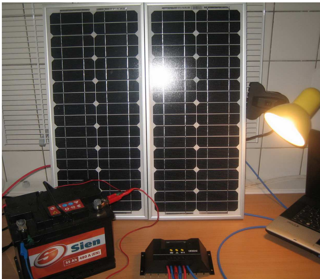
Ukázka měřicího stanoviště laboratorní úlohy Autonomní fotovoltaický systém
